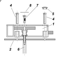
Die Befestigung des Schloßmoduls (1) auf vier sich auf einer Ebene befindlichen Befestigungspositionen (2) erfolgt mittels vier Schauben M6 oder 1/4 Zoll (4), die in die vier vorgesehenen Öffnungen des Schloßmoduls eingeführt werden. Eine Öffnung des Deckels ist dafür nicht notwendig und auch nicht
