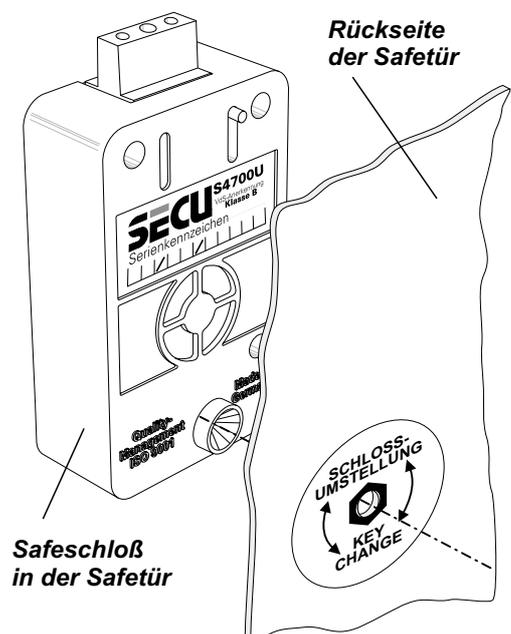
4. Führen Sie nun von der Schloßrückseite den Sechskant-Umstellschlüssel in die Umstell-Schlüsselöffnung ein und drehen Sie diesen Sechskant-Umstellschlüssel mit Blick auf die Umstell-Schlüsselöffnung gegen den Uhrzeigersinn um 60 Grad bis zum Anschlag.
