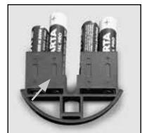
Schuif het deksel samen met de batterijen terug in de vergrendelingselektronica en draai de schroeven weer vast.
