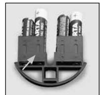
Skjyv lokket og batteriene inn i låselektronikken igjen, og skru det fast.
