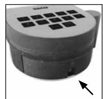
Выверните винта на нижней стороне электронного устройства замка. Для этого вам потребуется отвертка с битой Torx T8. Входит в комплект поставки.
