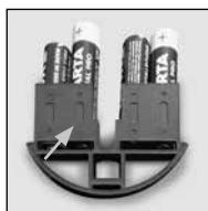
Umiestnite kryt spolu s batériami späť do elektroniky zámku a pevne ho priskrutkujte.
