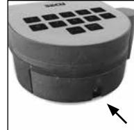
Fjern de skruen på undersiden af låsens elektronik. Hertil skal du bruge Torx T8 skruetrækker. Den er inkluderet i leveringsomfanget.
