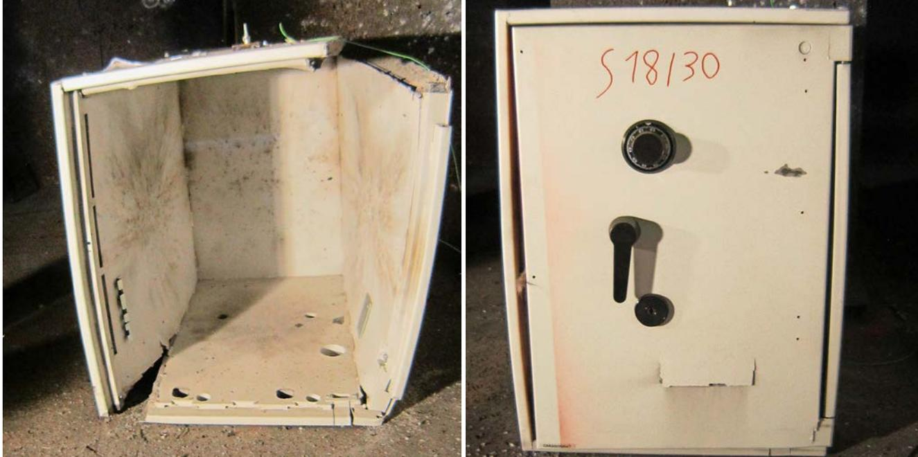
Das Ergebnis einer Explosion mit 150 Gramm Festsprengstoff: Der linke Geldautomaten-Tresor ohne eingesetzte EAM wurde durch die Wucht auseinandergerissen, den rechten Tresor mit verbauten EAM konnte die extreme Explosion hingegen nicht öffnen.
