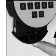
Verwijder de verbruikte batterijen en voer deze af volgens de afvoerinstucties op pagina 29. Vervang de batterijen door vier nieuwe 1,5 V AA Mignon-batterijen en let op de juiste polariteit. Hiervoor zijn afbeeldingen op de batterijhouder te zien. Gebruik a.u.b. merkbatterijen en geen oplaadbare batterijen.
