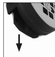
Entfernen Sie die alten Batterien und entsorgen Sie sie gemäß der Entsorgungshinweise auf Seite 8. Ersetzen Sie die Batterien durch vier neue 1,5 V AA Mignon-Batterien und gemäß der korrekten Polung. Hierzu sind Abbildungen auf der Batteriehalterung dargestellt. Bitte benutzen Sie Markenbatterien und keine Akkus.
