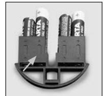
Entfernen Sie die alten Batterien und entsorgen Sie sie gemäß der Entsorgungshinweise auf Seite 8. Ersetzen Sie die Batterien durch vier neue 1,5 V AA Mignon-Batterien und gemäß der korrekten Polung. Hierzu sind Abbildungen auf der Batteriehalterung dargestellt. Bitte benutzen Sie Markenbatterien und keine Akkus.
