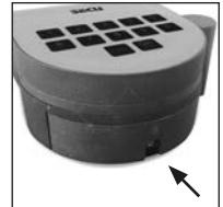
Entfernen Sie die Schraube auf der Unterseite der Schlosselektronik. Hierzu benötigen Sie einen Torx T 8 Schraubendreher. Dieser ist im Lieferumfang enthalten.
