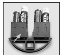
Verwijder de verbruikte batterijen en voer ze af volgens de instructies op pagina 8. Vervang de batterijen door vier nieuwe 1,5 V AA Mignon-batterijen en let op de juiste polariteit. Hier voor zijn afbeeldingen op de batterijhouder te zien. Gebruik alleen merkbatterijen en geen oplaadbare batterijen.
