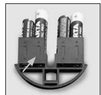
Empurre a tampa e as pilhas de volta para a fechadura eletrônica e aperte-as firmemente.
