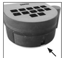
Rimuovere la vite sul lato inferiore dell'elettronica di chiusura. In questo caso è necessario un cacciavite Torx T8. Questo è incluso nella dotazione.
