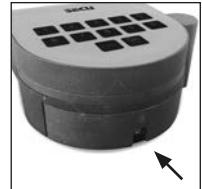
Îndepărtați șurubul de pe partea inferioară a blocului electronic al încuietorii. În acest scop este necesară o șurubelnită Tork T 8. Aceasta este inclusă în pachetul de livrare.
